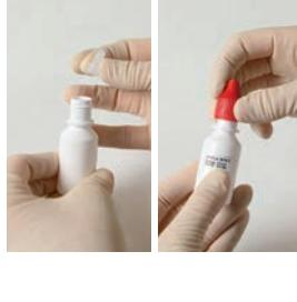
Una vez añadido todo el líquido al bote gotero, se coloca a presión el tapón dosificador.
